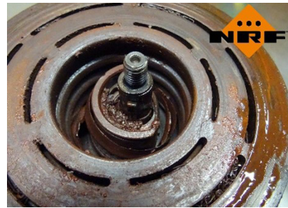
Foto 2: Contaminación de la polea del compresor que sugiere una fuga de aceite
