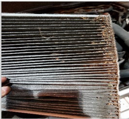
Photo 3 . Filtro de cabina contaminada
