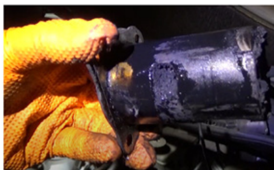
Válvula original desmontada del vehículo
