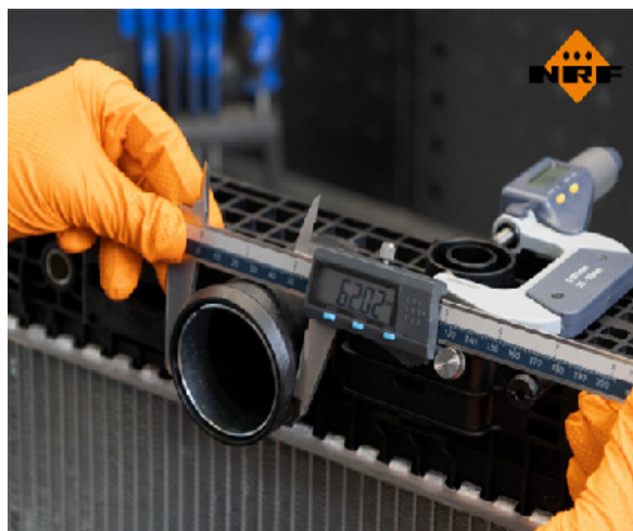
(Fig. 6) Proceso de medida de los puntos de conexión.
