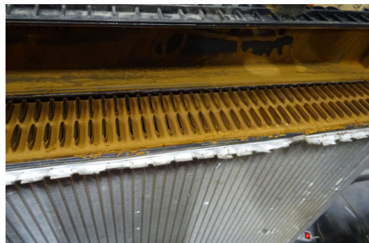
(Fig. 3 y 4) Ejemplo de utilización de un refrigerante inadecuado.
