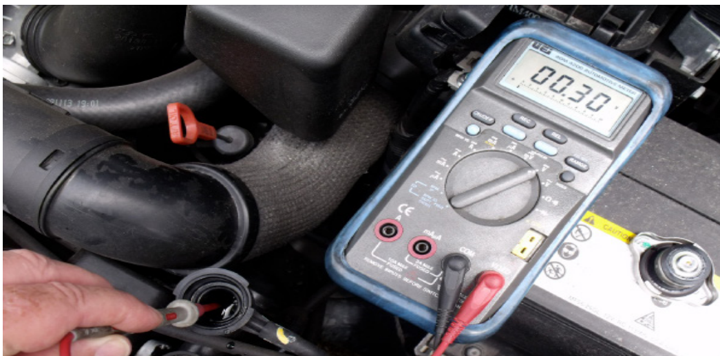
Mesure du voltage du liquide de refroidissement
