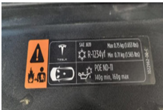
Image 5. Informations sur le réfrigérant et l'huile affichées sur la plaque spéciale sous le capot de la Tesla Model S NRF
