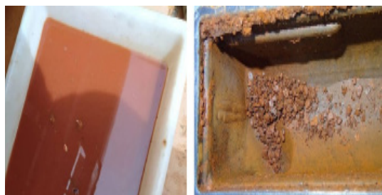
Photos 4 et 5 : Échantillon d'eau du robinet utilisé comme liquide de refroidissement, et corrosion du moteur (photo NRF)
